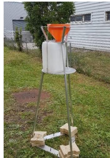
Les plaquettes qui étaient jusqu'à présent utilisées pour la mesure des poussières sédimentables sont remplacées par des jauges de 10 L maintenues par un trépied.
