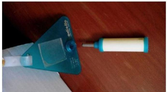
Photo 3 : Détail du tube à diffusion : corps diffusif, cartouche à diffusion et plaque de support.
