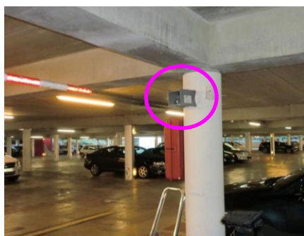
Echantillonneurs passifs dans le Parking souterrain P2
