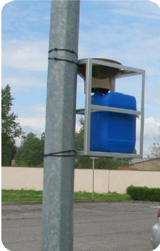
Les « retombées » représentent la masse de matières naturellement déposées par unité de surface dans un temps déterminé (norme NFX43.001).
