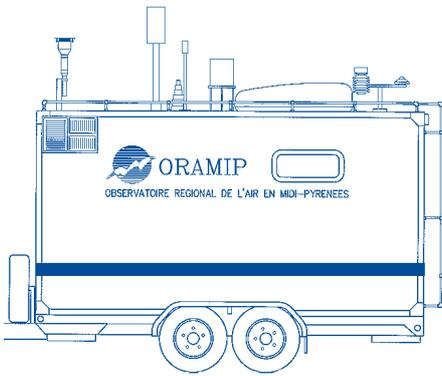
Prises d'échantillons pour la mesure des particules fines en suspension
