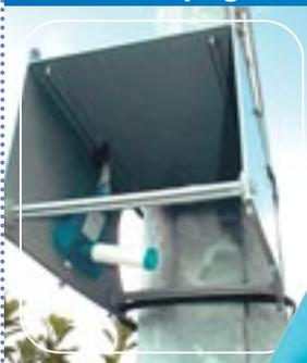
Tube échantillonneur passif en place
