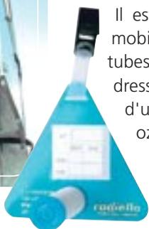
Tube échantillonneur passif
