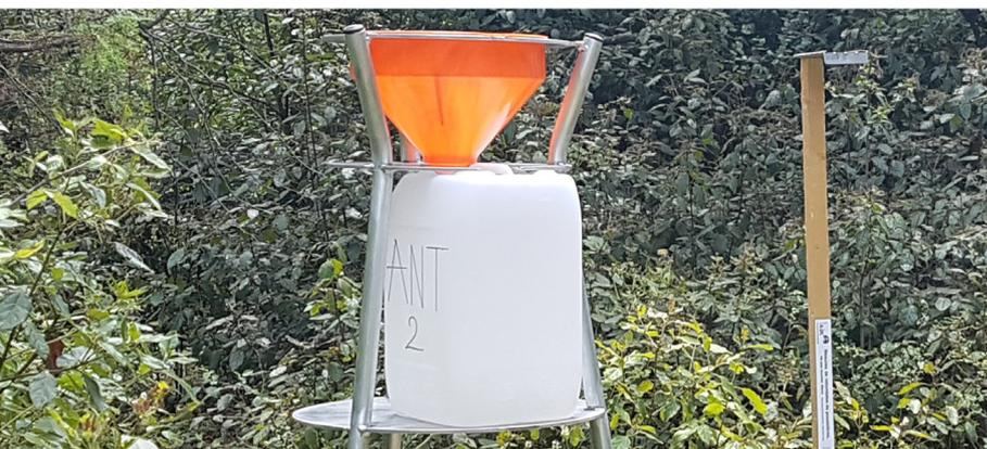
**La jauge d'OWEN** est constituée d'un récipient de collecte et d'un entonnoir. Ce dispositif permet de collecter les retombées atmosphériques totales qui se composent des retombées sèches et des retombées contenues dans les eaux pluviales.
