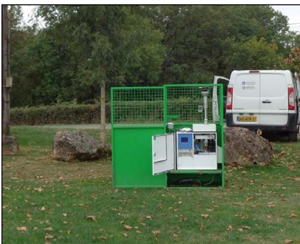
Préleveur de particules PM<sub>10</sub> – Station de mesure
