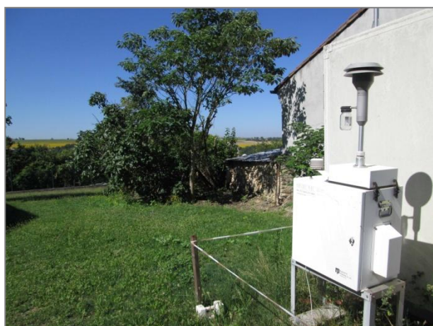
Préleveur de particules PM 10 – Station de Bélesta -en- Lauragais
