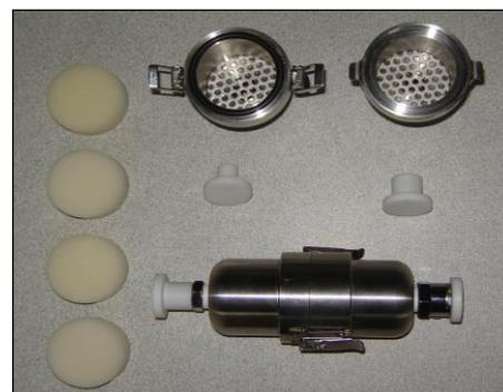
Ces supports de prélèvement sont conditionnés préalablement selon deux techniques différentes. Le filtre en fibre de quartz est calciné à 525°C pendant 4 heures et la mousse en polyuréthane est lavée au Soxtec pendant 1h30 avec un mélange hexane/dichlorométhane.
