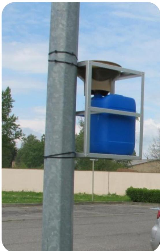
« Le collecteur de précipitation » de type jauge est un dispositif destiné à recueillir les retombées atmosphériques. Les « retombées » représentent la masse de matières naturellement déposées par unité de surface dans un temps déterminé (norme NF X43.001).
