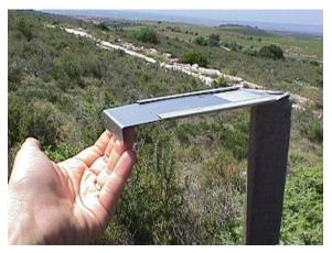
Les retombées atmosphériques sèches se déposent sur une plaquette métallique enduite d'un fixateur, de dimension 5cm x 10cm, installée horizontalement à 1,5 m de haut.
