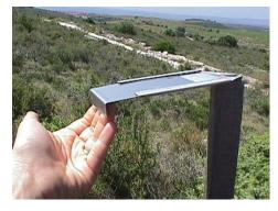
Les poussières sédimentables se déposent sur une plaquette métallique de surface connue (50 cm²), enduite d'un fixateur et installée horizontalement à 1,5 m de haut (voir photo ci-contre) Les mesures se font dans un environnement dégagé, permettant la libre circulation des poussières autour du dispositif.
