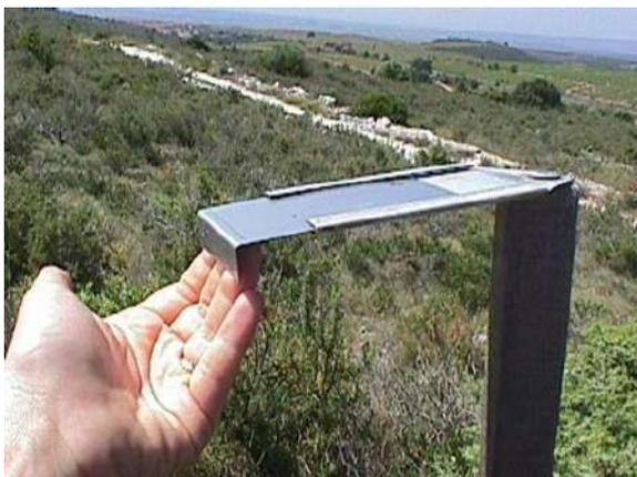
Les retombées atmosphériques sèches se déposent sur une plaquette métallique enduite d'un fixateur, de dimension 5 cm x 10 cm, installée horizontalement à 1,5 m de haut. Chaque plaquette est repérée par un numéro et possède une surface utile d'exposition de 50cm<sup>2</sup>.
