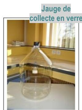
En plus des prélèvements en air ambiant, le protocole de mesures prévoit la pose des 2 jauges en verre pour la collecte des retombées de poussières dans l'eau de pluie. Une jauge a été positionnée au niveau de la D622 à proximité directe de l'exploitation avicole, et une autre jauge a été placée au niveau du château du Gua, distante de 350 mètres de la première.
