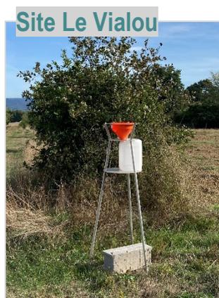
Le protocole de mesures prévoit la pose de 5 jauges pour la collecte des retombées totales de poussières (en phase sèche et humide). Les prélèvements de collecte sont exposés durant 1 mois, en continu durant toute la campagne. En l'absence de réglementation française pour la mesure de retombées totales, le seuil qui servira de référence est de la réglementation en Allemagne (TA Luft).
