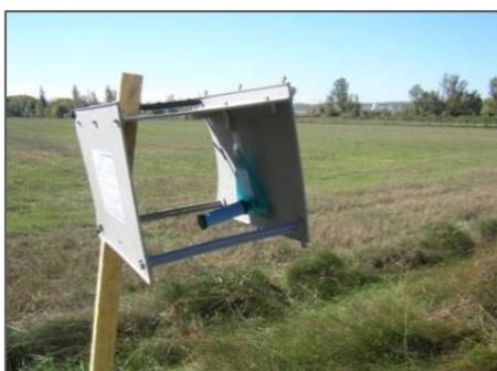
Figure 2 : Dispositif d'échantillonnage du NH<sub>3</sub>
