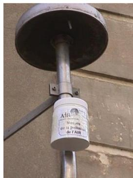
Après cette période d'exposition, le dioxyde d'azote est analysé a posteriori par un dosage colorimétrique qui permet de connaître la concentration du NO<sub>2</sub> dans l'air ambiant. La préparation, la pose, le ramassage puis l'analyse des tubes sont réalisés par ATMO Occitanie.
