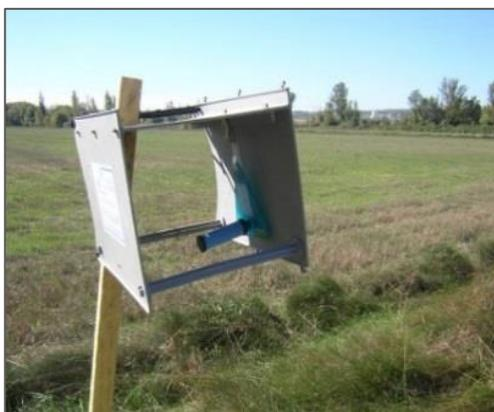
Figure 2 : Dispositif d'échantillonnage du NH<sub>3</sub>
