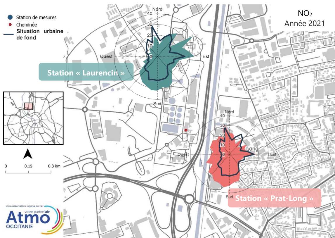
Rose de pollution du dioxyde d'azote (NO 2 ) sur les deux stations "Laurencin" et "Prat-Long".
