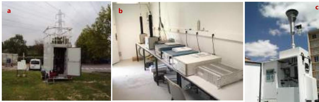
Remorque mobile renfermant les analyseurs installés sur le site de Laurencin (a), exemple d'analyseurs automatiques utilisés pour le NO<sub>2</sub> et PM<sub>10</sub>/PM<sub>2,5</sub> et pour la mesure des métaux (c).
