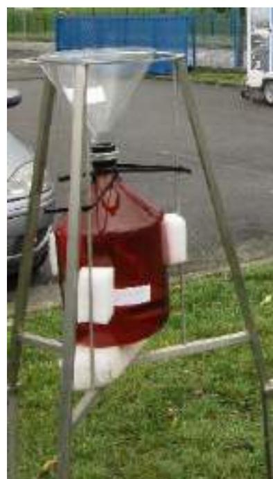
Photographie des jauges Owen utilisées durant les campagnes d'hiver pour la mesure des retombées totales. Les jauges en verre sont indispensables pour la mesure des dioxines et furanes.
