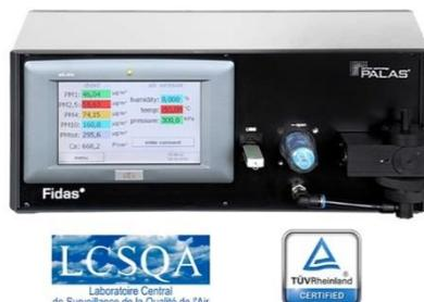
Le granulomètre FIDAS 200 est le seul analyseur optique au monde à avoir été certifié par le TÜV pour la mesure réglementaire en continu et en temps réel des fractions PM-10 et PM-2,5, simultanément.
