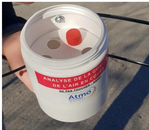
Après cette période d'exposition, le dioxyde d'azote est analysé a posteriori par un dosage colorimétrique qui permet de connaître la concentration du NO<sub>2</sub> dans l'air ambiant. La préparation, la pose, le ramassage puis l'analyse des tubes sont réalisés par ATMO Occitanie.
