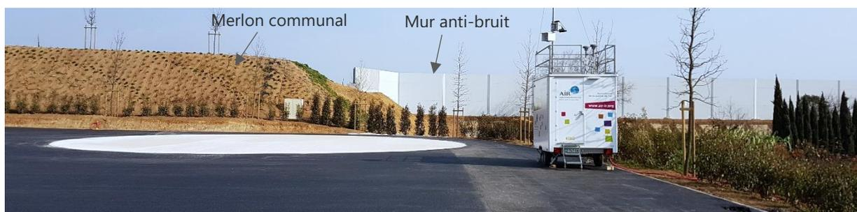
Une station de mesures a été installée au niveau de l'espace Bessèdes, à proximité du merlon communal (voir carte au paragraphe 2.2). Dans cette station, des mesures en continu sont réalisées pour le dioxyde d'azote (NO<sub>2</sub>) ainsi que pour les particules en suspension PM<sub>10</sub>, et les particules fines PM<sub>2,5</sub> et PM<sub>1</sub>. Elles permettent le suivi de l'évolution des concentrations de ces polluants au cours des différentes journées.
